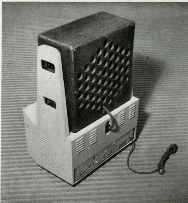
13 a, b. La custodia in metallo avvolge tutto il ricevitore proteggendolo efficacemente dalla polvere dagli urti meccanici e dai disturbi radioelettrici, la custodia in legno contiene l'altoparlante costituendone lo schermo acustico più adatto. La microfonicità AF-riproduttore è completamente eliminata dalle sospensioni ad anelli elastici. Il telaio è quello di una nota casa torinese. Si vede chiaramente come le necessità della funzione e dell'uso hanno imperiosamente influito, con ottimo effetto, nell'estetica della custodia realizzata da Caccia Dominioni e dai F.lli Castiglioni.
