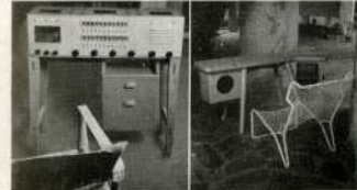
11. Ecco un silenzioso e semplice aspetto dell'amplificatore per sculture e collettività. Notevole la grande semplicità e comodità di manovra dovuta alla razionale disposizione dei comandi, che, secondo all'apparecchio si trovano tutti a portata di mano.
